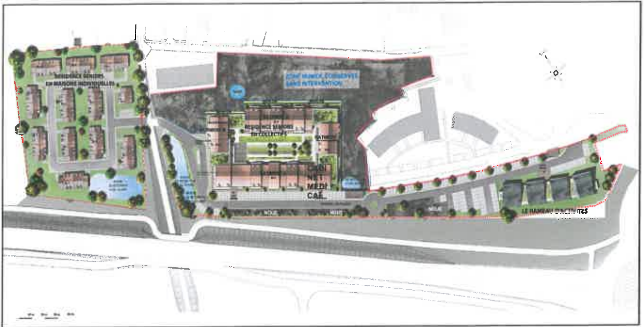
Vue d'artiste du projet finalisé avec les ouvrages de gestion des eaux pluviales
